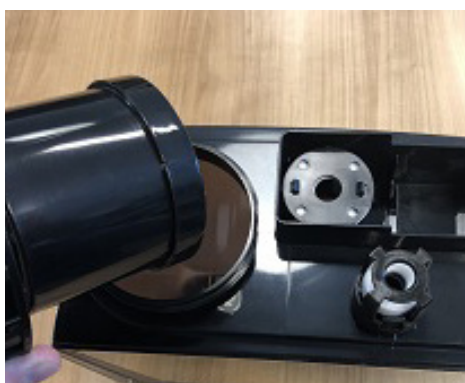
Capac și filtru rezervor de apă
