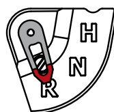
«Remontage» Winding position (P. 9)
