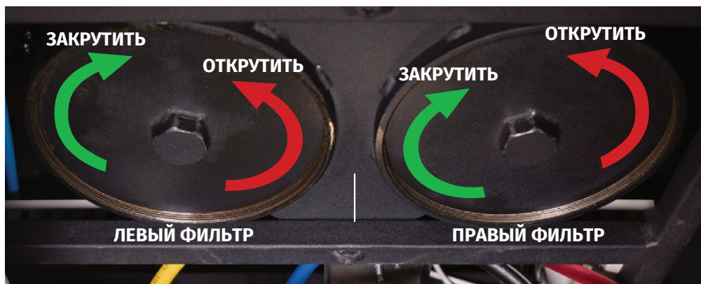
Рисунок 9. Направление вращения крышки при замене фильтров MS0101
