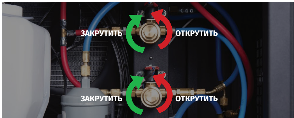
Рисунок 13. Направление вращения крышки при замене фильтров MS0102
