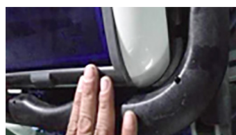
8. Tryk på de to sider af håndtaget for at lukke det ned
