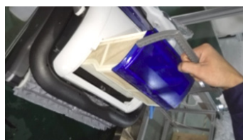
2. Nosta suodatinkotelo pois
