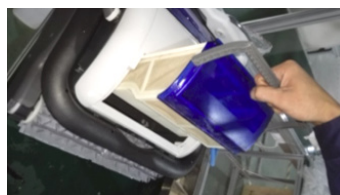
2. Lyft ut filterfacket
