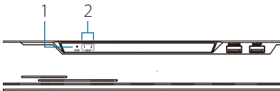
Figura 1: Indicatori LED del pannello frontale
