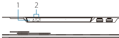
Figura 1: Indicadores LED del panel frontal
