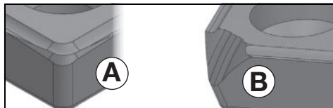
Fig. A: normalt slitage: Vrid vändskärplatta/byt ut.
