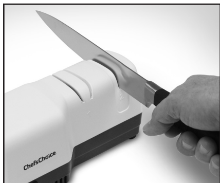
Figura 4. Cuchillo en la etapa 2. Realice pasadas de afilado hacia adelante y hacia atrás y ejerza una presión leve hacia abajo. Leer el texto.
