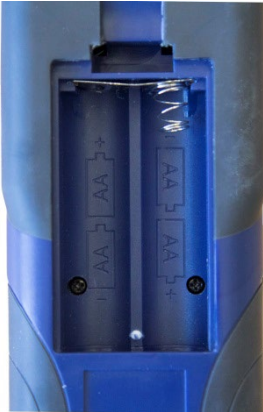
Abb. 6: Geöffnetes Batteriefach auf der Geräterückseite
