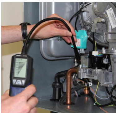
Abb. 5: Der Gasspürer zeigt ein deutliches Signal, wenn er an den leicht geöffneten Messsstutzen gehalten wird.
