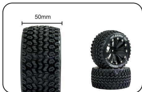
Roues collées sur les jantes Tyres glued on rims „ST Hummer“ Ø 100 mm No.05 2866 12 mm 1/2OS
