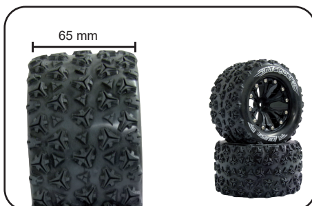
Roues collées sur les jantes Tyres glued on rims „MT Spider“ Ø 115 mm No.05 2857 12 mm 1/2OS
