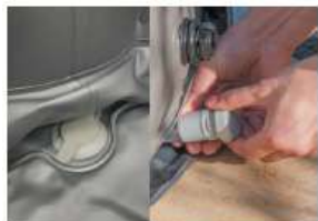
13) Vérifiez que les bouchons de vidange sont bien serrés.
