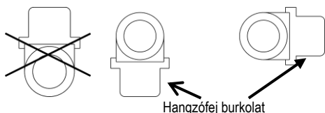
6. ábra: Ajánlott beépítési terület a hűtési energia mérőnél
