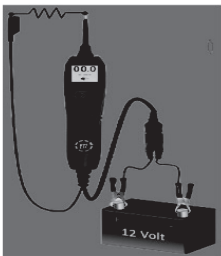
Durchgang (weniger als 20k Ohm aber mehr als ca. 650 Ohm)
