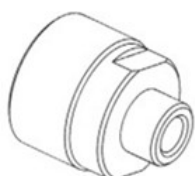
Adaptateur A – pour libération rapide écrou de cassette
