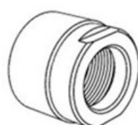
Adapter C – voor steekas cassettesluitring
