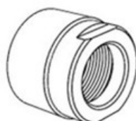
Adaptateur C – pour axe traversant écrou de cassette
