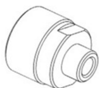
轉接頭 A - 快拆齒盤螺母
