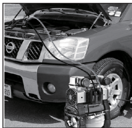
Accu via kabels (DC)
