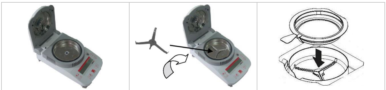
(1) Zugluftschutz installieren und positionieren
