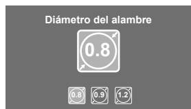
Selección de electrodo / diámetro del alambre:
