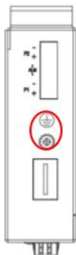
Рисунок 4 — Вит заземления на коммутаторе
